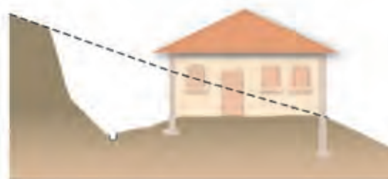
Plate-forme en déblais
